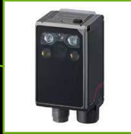
Keyence Camera - SR-X100W (Japan) Kamera single-scan untuk verifikasi terhadap hasil 2D Barcode yang di cetak, dilengkapi fitur autofocus dan quality check threshold.
